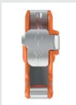
El **V-Proof System** de **CLICK UP+** se compone de un elemento separador móvil que favorece la activación del sistema de frenado asistido. Si durante la caída del escalador la cuerda lado frenado entra en contacto con el separador, esto favorece la rotación de dispositivo y el consiguiente bloqueo de la cuerda.
